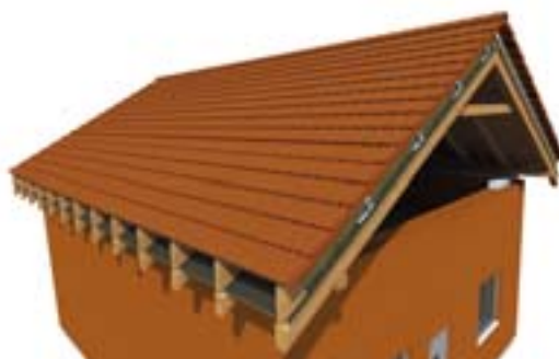
12. Kladenie strešnej krytiny
