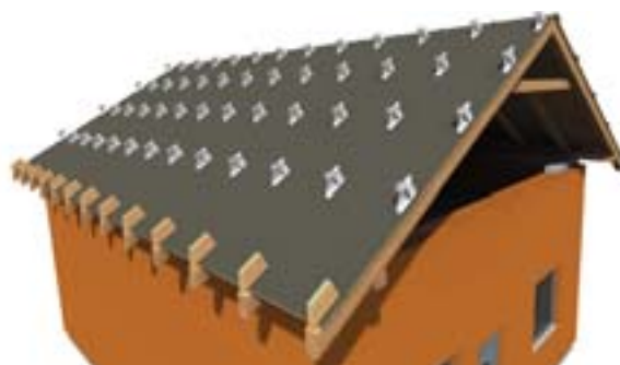
4. Montáž kovových držiakov a ukončovacích drevených hranolov
