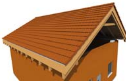
13. Obloženie konštrukcie šikmej strechy
