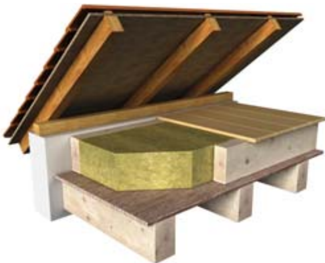
Zateplenie pochôdznej podlahy na povale – izolácia medzi trámovou konštrukciou
