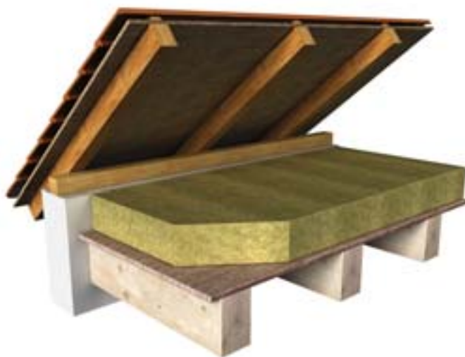
Zateplenie nepochôdznej podlahy na povale – izolácia v baloch v súvislej vrstve
