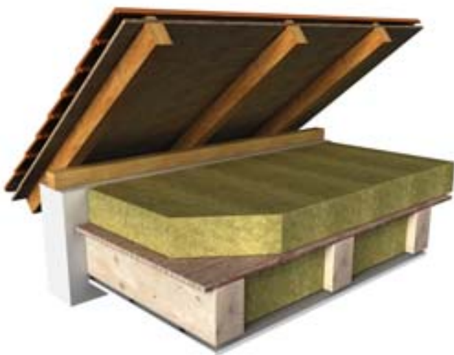
Zateplenie nepochôdznej podlahy na povale – izolácia nad trámami a medzi nimi
