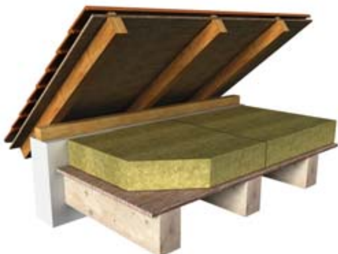
Zateplenie nepochôdznej podlahy na povale – izolácia v doskách v súvislej vrstve
