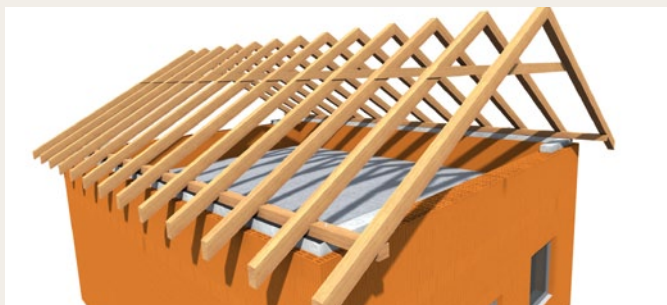
1. Krokvy pripravené na montáž debnenia
